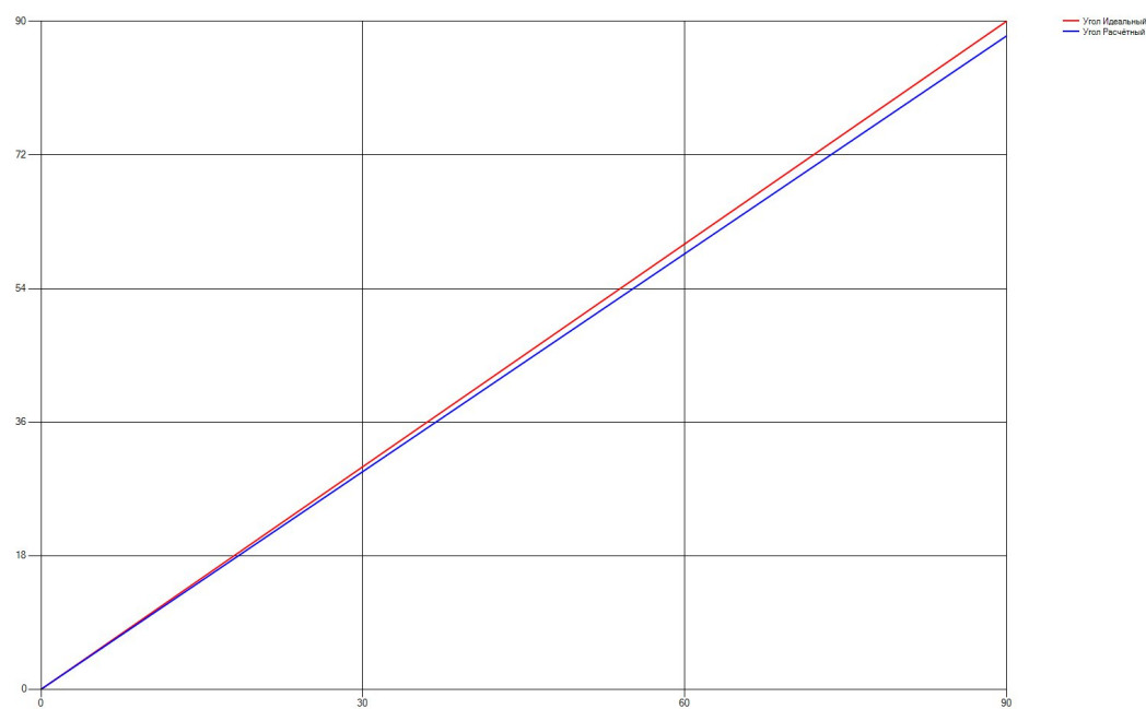
Рисунок 14 - Расчёт угла поворота на 90 градусов с дискретизацией 30 градусов
