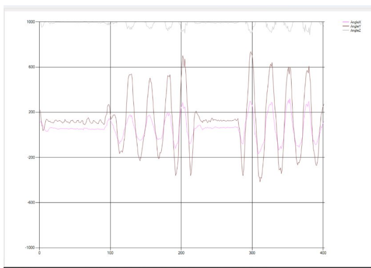
Рисунок 34 - График значений инерциальной системы во время движения по оси Y
