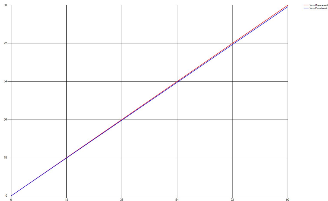
Рисунок 13 - Расчёт угла поворота на 90 градусов с дискретизацией 18 градусов
